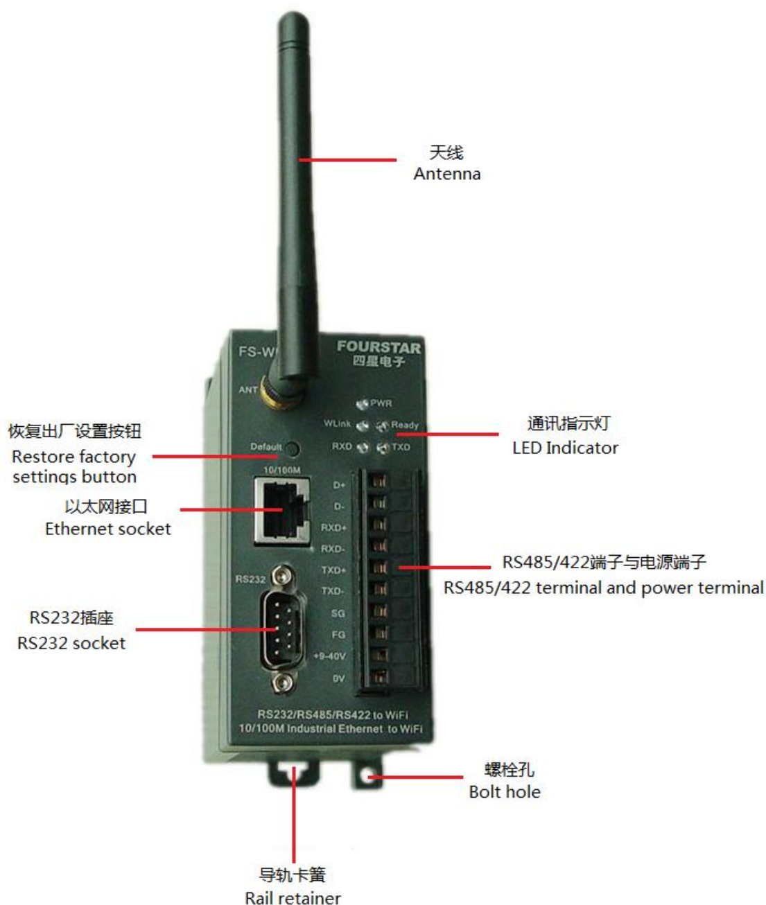
图3-1 FS-WF485IE的外部结构及各部件说明
