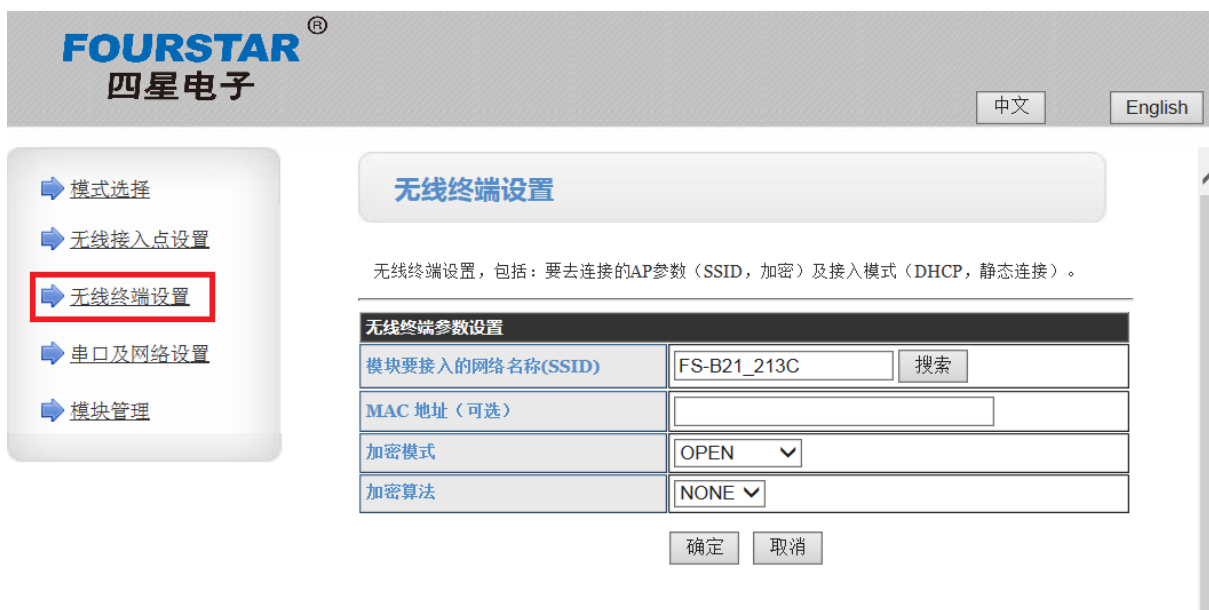
图4-4 无线终端（Station）的设置
